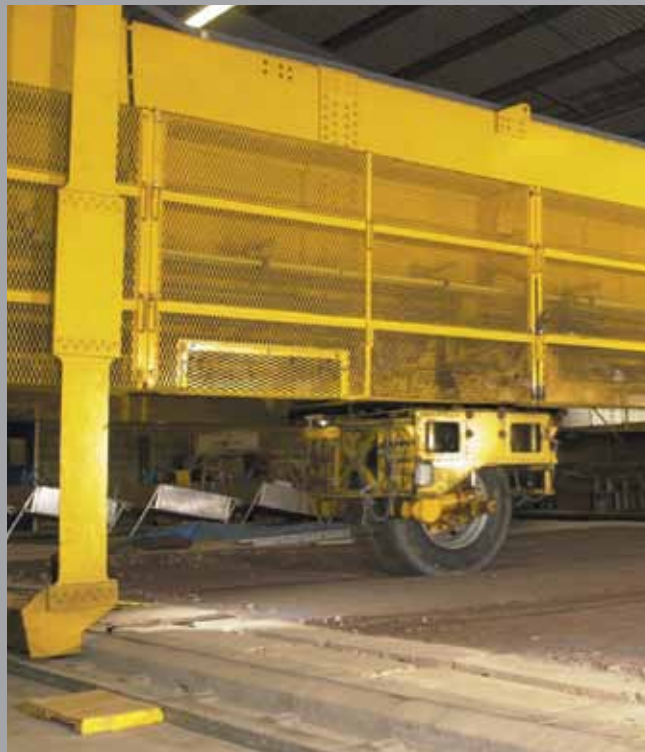
2000 – Fullskala laborietester hos UK Transport Research Laboratory sammenligner Tensar geonett med alternative typer geonett.
